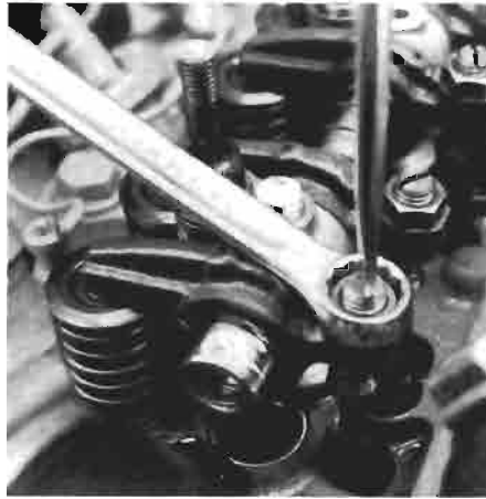
Einstellen des Ventilspiels. Réglage du jeu des soupapes.
