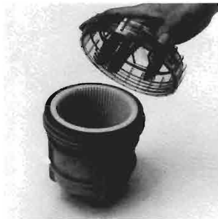
Control del filtro del agua de refrigeración. Controllo del filtro dell'acqua di raffreddamento.
