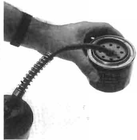
Inoliën rubber ring. Oiling the oil seal.
