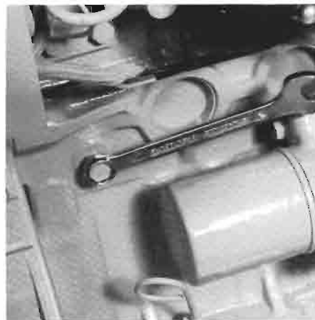
Retirar el tapón de vaciado. Rimozione del tappi di scarico.
