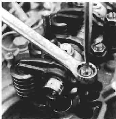
Ajuste de la holgura de las válvulas. Regolazione del gioco tra le valvole.
