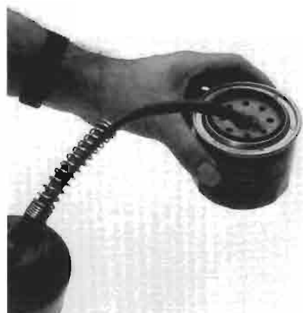
Engrasar la empaquetadura de caucho. Oliatura dell'anello di gomma.
