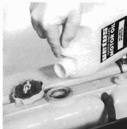
Einfüllen des Öls. Le remplissage.
