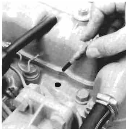
Gloeipluggen verwijderen. Removal of glow plugs.
