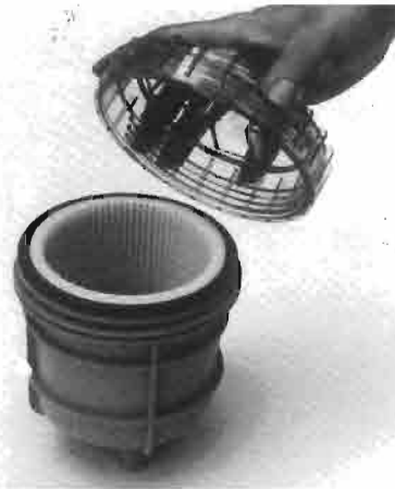
Kontrolle des Kühlwasserfilters. Contrôle du filtre à eau de refroidissement.
