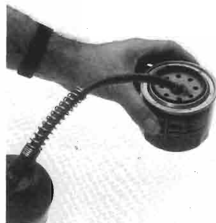
Einölen des Gummiringes. Graissage de la garniture en caoutchouc.
