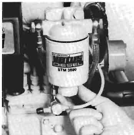
Desaguar el separador de agua. Scarica dell'acqua dal separatore dell'acqua.
