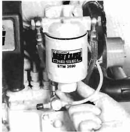
Wasserabscheider entleeren. Purge du séparateur d'eau.
