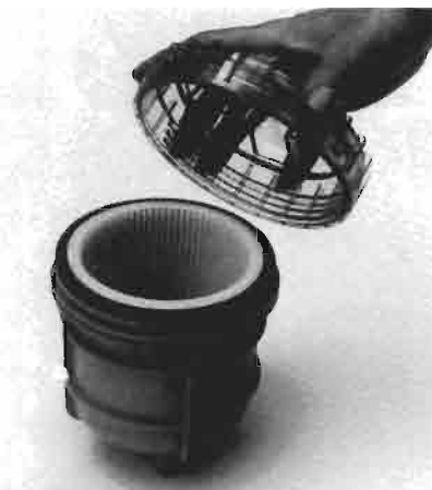
Überprüfen des Kühlwasserfilters. Contrôle du filtre à eau de refroidissement.
