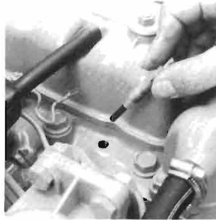
Glühkerzen entfernen. Dépose des bougies incandescentes.
