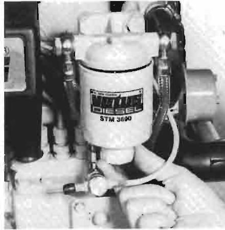
Vaciado del separador de agua. Scarico del liquido dallo scambiatore di calore.
