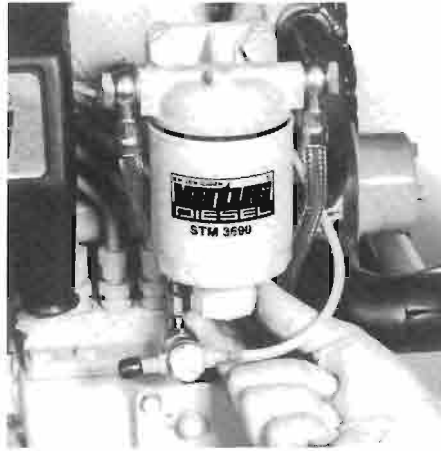
Wasserabscheider ablassen. Purge du séparateur d'eau.
