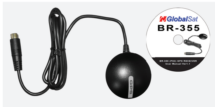
PS/2 Mini DIN 6-Pin Male Connector
